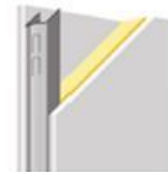
Insulated metal stud drywall
